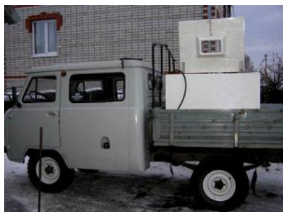
Рис. 22. Живорыбный контейнер в кузове автомобиля
