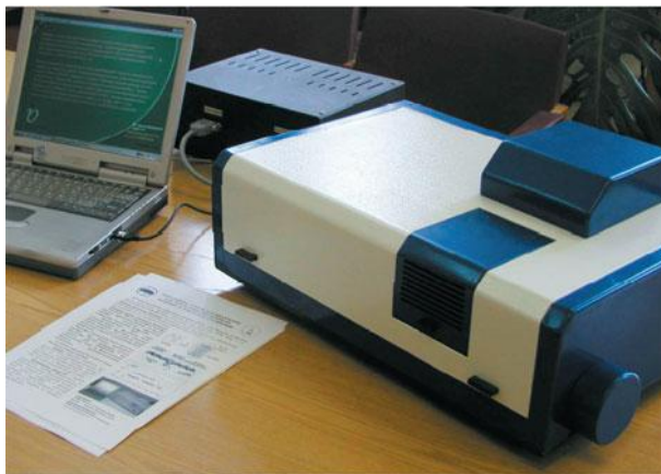
Рис. 12. Биоаналитическая система на базе портативного дихрометра и биодатчиков на основе частиц жидкокристаллической дисперсии нуклеиновых кислот.
