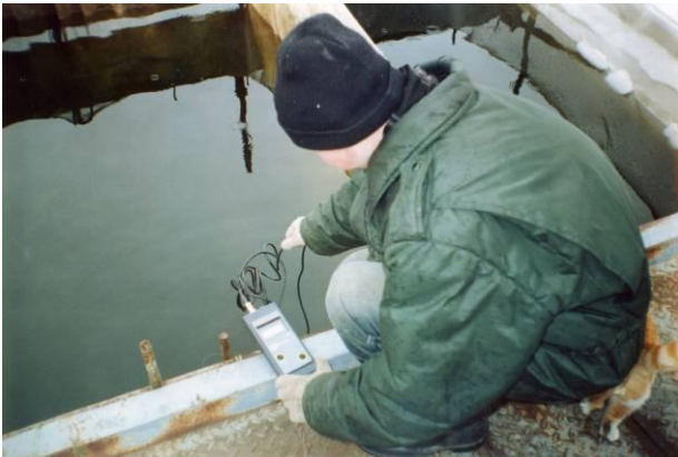
Рис. 14. Измерение кислорода в воде садка при помощи оксиметра HI-9142.
