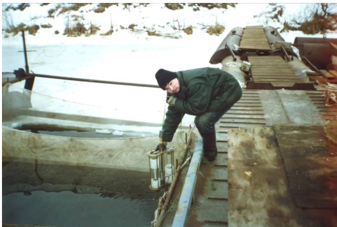
Рис.12. Отбор пробы воды из садка с помощью батометра с одновременным определением её температуры выполняет А.В. Зарубин
