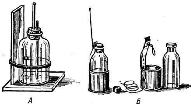
Рис. 28. Упрощенный батометр: А – бутылка с шестом; Б – то же, с грузилом.
